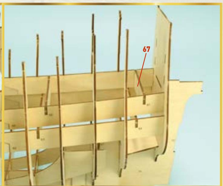
**5** Вставьте поперечные распорки (66) и (67) в соответствующие пазы деталей (65). Склейте между собой эти четыре детали, обращая внимание на то, чтобы не приклеить их к другим элементам каркаса (включая шпангоуты).
