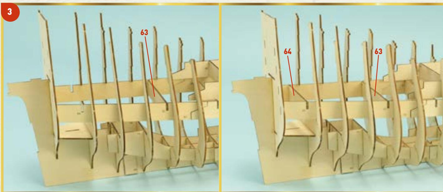
**3** Вставьте поперечные распорки (63) и (64) в соответствующие пазы деталей (62). Склейте между собой эти четыре детали, обращая внимание на то, чтобы не приклеить их к другим элементам каркаса (включая шпангоуты).
