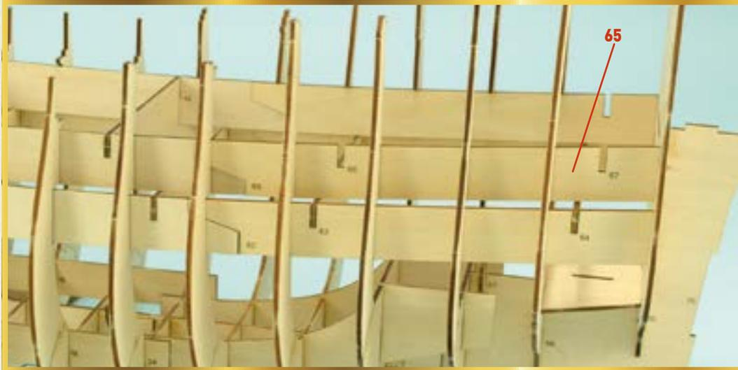
**4** Возьмите две детали (65) и установите их на каркас модели (по одной с каждой стороны) так, как показано на фотографии. При этом шипы на задних концах деталей должны войти в соответствующие пазы последнего шпангоута.
